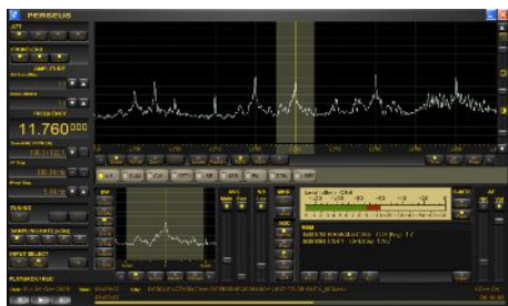
PLC モデムによるファイル転送中の受信状態
