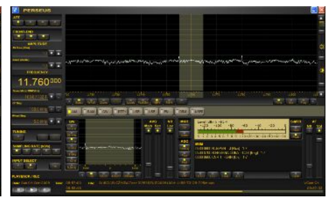
PLC稼働中 (ファイル転送中)
